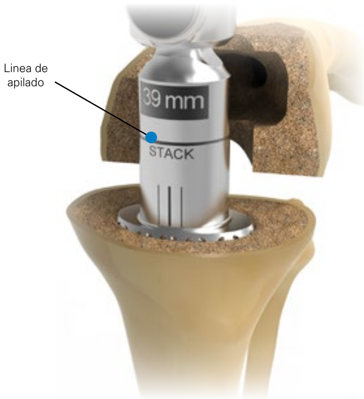
Figura 6 Escariado de la tibia - Apilado
