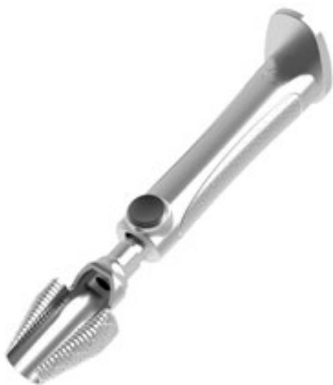
Figura 12 Ensamblado del mango del escariador
